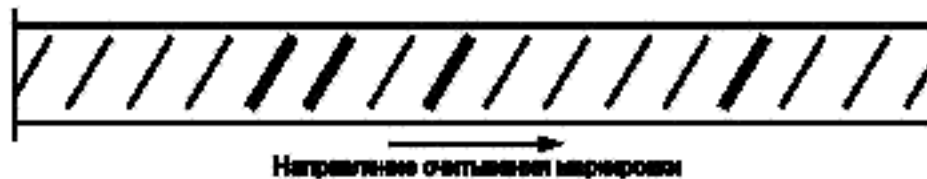
Рисунок 2 — Пример прокатной маркировки предприятия-изготовителя под номером 14
